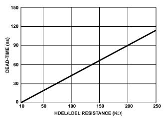
FIGURE 5. MINIMUM DEAD-TIME vs DEL RESISTANCE
